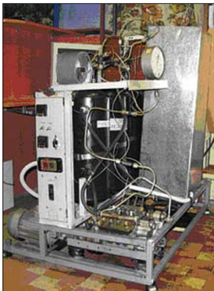
Рис.3. Лабораторный стенд для реализации непрерывного режима сверхкритического безкаталитического метанолиза
