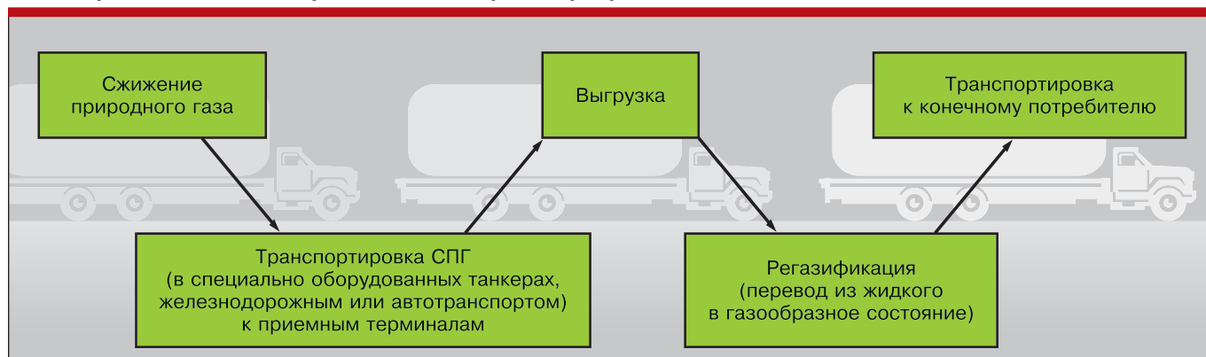
Рис. 1. Простейшая схема производства и транспортировки СПГ
