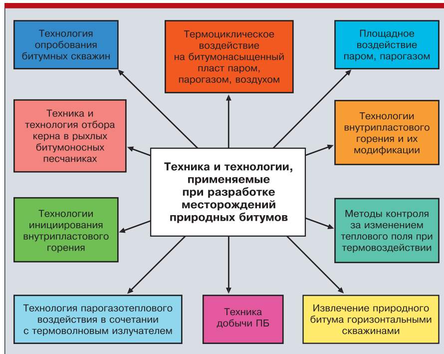
Схема 4. Техника и технологии, применяемые при переработке природных битумов
