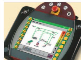
С мая этого года для всех роботов «компактной» и «стандартной» серий — в дополнение к системе управления CNC6.2 с графической приборной доской — поставляется и новая сенсорная система управления R7. Отдельные функции и режимы можно выбирать и программировать при помощи сенсорного экрана
