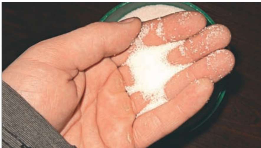
Суперабсорбент поглощает влагу, количество которой в сотни раз превышает вес самого суперабсорбента
