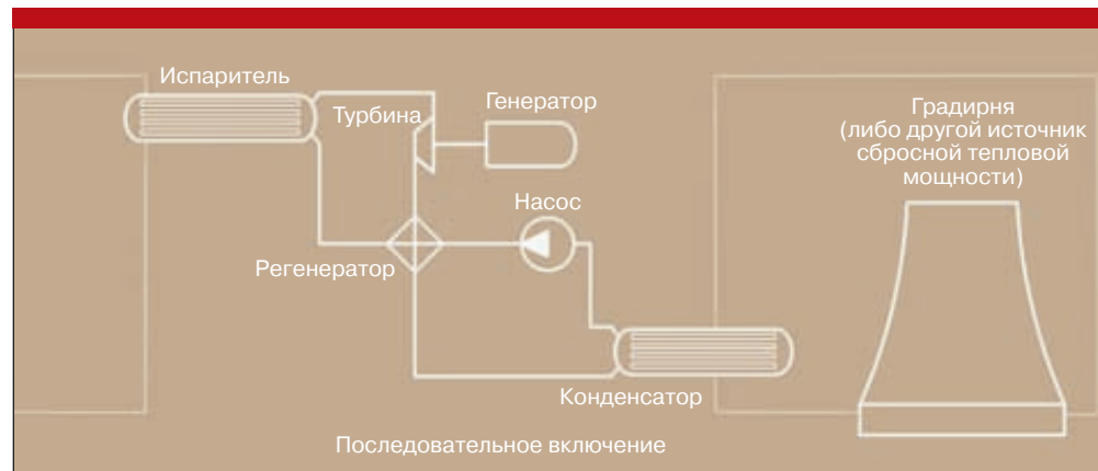
Рис. 6. Схема использования тепла градирен для выработки электроэнергии
