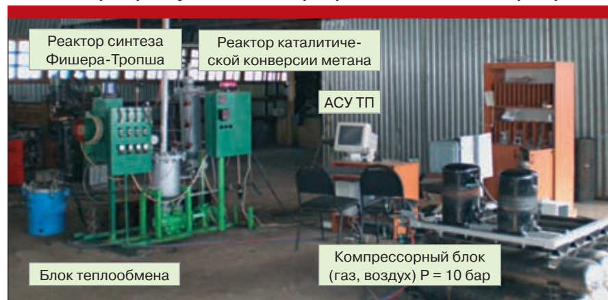
Рис. 3. Лабораторная установка для трехфазного синтеза Фишера-Тропша
