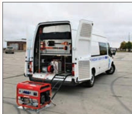
Мобильная экологическая лаборатория (МЭЛ-В) для контроля загрязнения воды и почвы, разработанная ЗАО «Экрос-Инжиниринг» для системы комплексного экологического мониторинга в зоне проведения XXII зимних олимпийских игр 2014 года в г. Сочи
